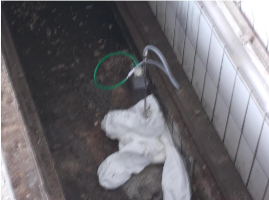
Bild 003: Bodenluftprobenahme an der Basis der Wartungsgrube
