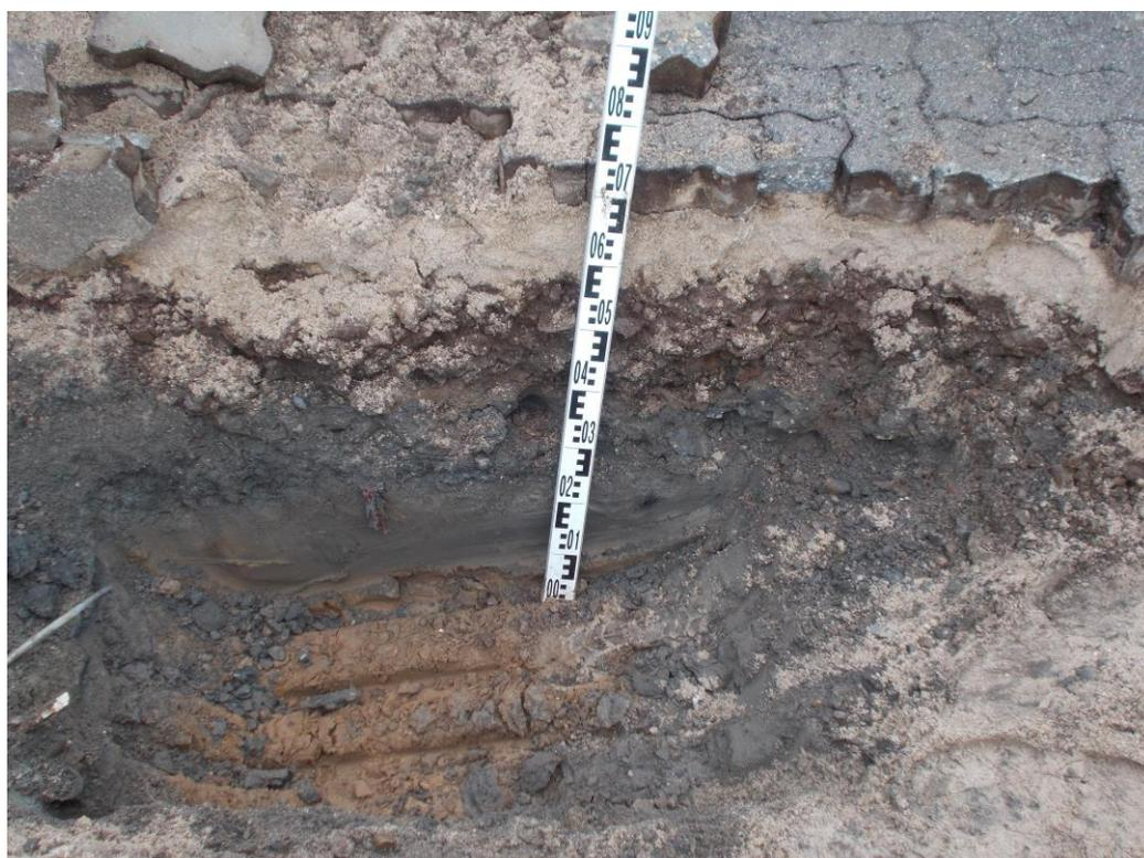
Bild 010: Schurf 2: Bndige Auffüllungen mit leichten Schadstoffbelastungen an Mineralöl.
