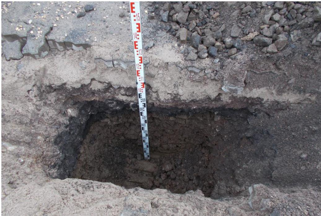
Bild 009: Schurf 1: „Schlackelage“ (schwarz) unterhalb der Tragschicht.
