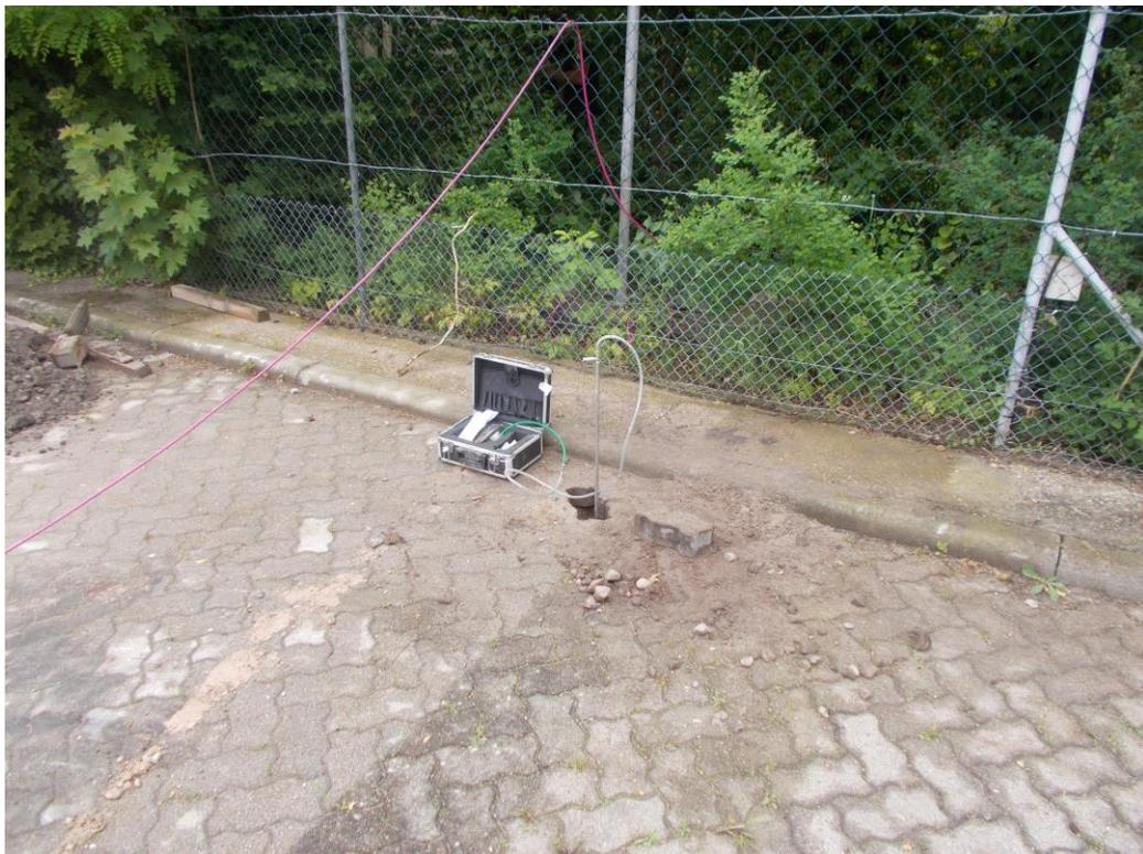
Bild 008: Bodenluftprobenahme neben Domschacht und ehemaliger Zapfstelle 40 m<sup>3</sup> Dieseltank.
